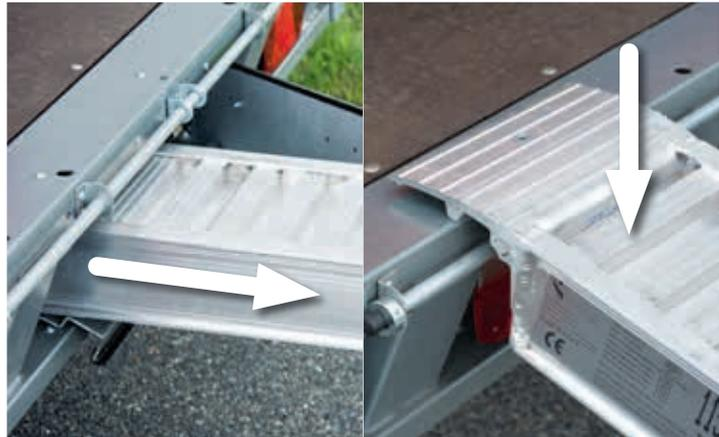
Einfach aus dem Führungsschacht ziehen und sicher einhängen
