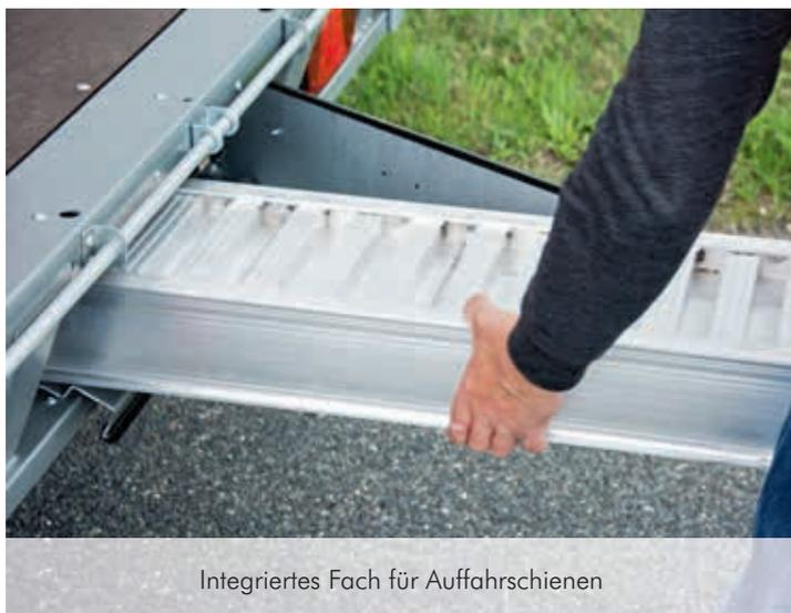
Integriertes Fach für Auffahrsschienen
